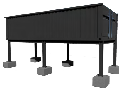
Sur une structure en acier
