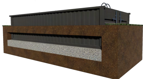
Partiellement enfoncé dans le sol
